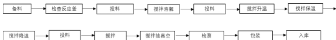
图 5 三防漆生产工艺流程图
